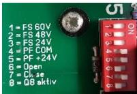
Mit diesen Schaltern werden die Eingänge äquivalent der Schalternummer eingestellt. Für den Eingang 1 ist der DS-1, für den Eingang 2 der DS-2, usw. zugeordnet. Zur Servicehilfe sind die Funktionen in Kurzform auf dem Print unten aufgedruckt.
